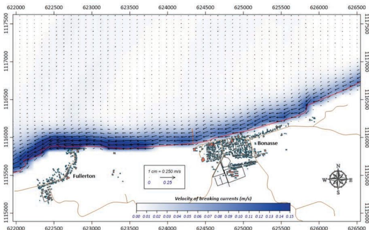
**Document 42** Exemple de la sortie d'un modèle de circulation côtière utilisé par Inversiones Gamma dans le cadre de son exécution du projet de restauration des plages exécutif à la plage de Bonasse à Cedros Bay, Trinidad et Tobago.
