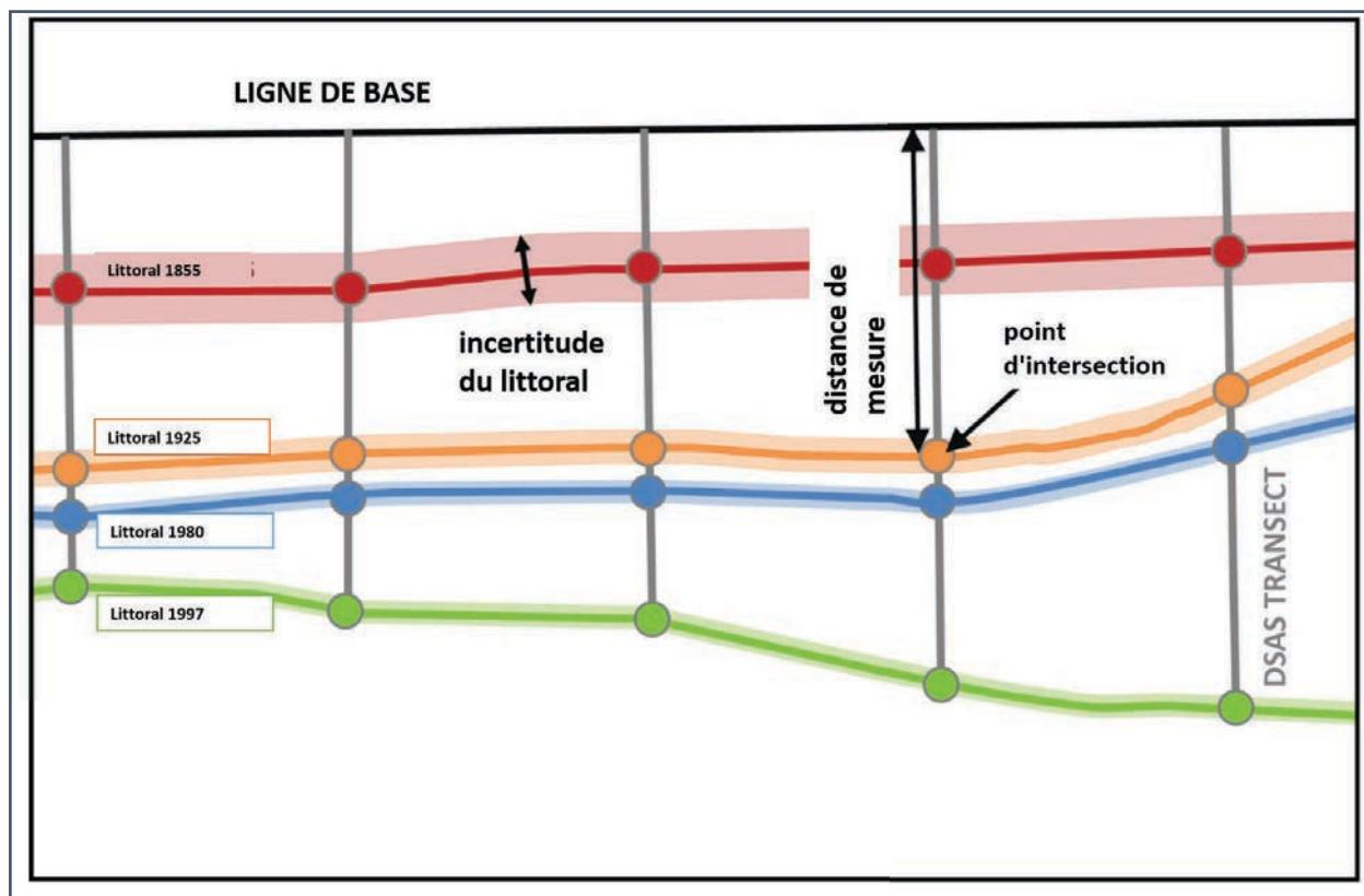
**Document 36** DSAS génère des transects qui sont projetés perpendiculairement à la ligne de base de référence avec un espacement spécifié par l'utilisateur le long de la côte. DSAS mesure la distance entre la ligne de base et chaque intersection de la ligne de côte le long d'un transect, et combine les informations de date et l'incertitude de position pour chaque ligne de côte.
