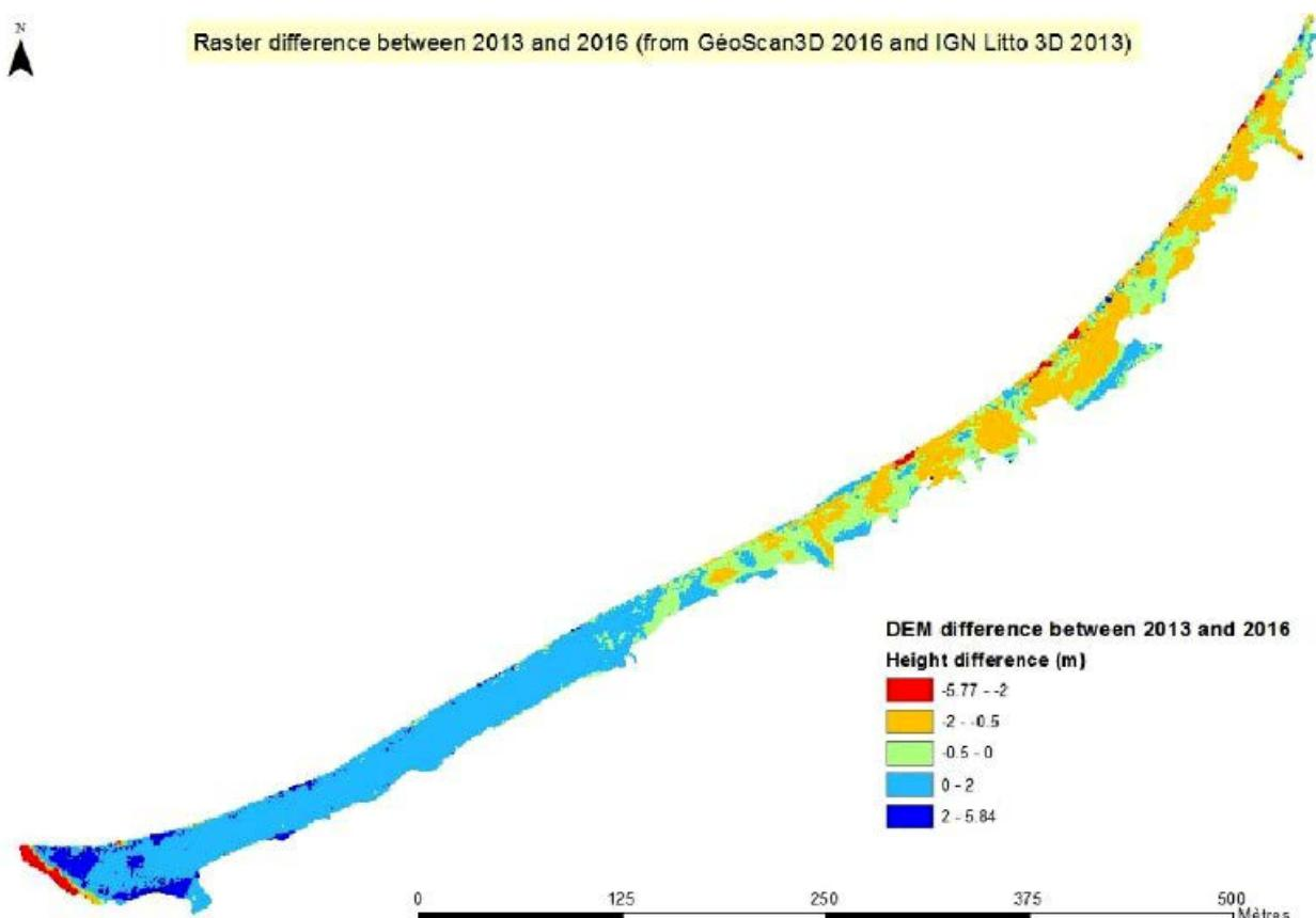
**Document 38** Analyse temporelle de la grille topographique : soustraction de l'élévation d'une date à l'autre pour obtenir l'érosion et l'accumulation pour chaque pixel (BRGM)
