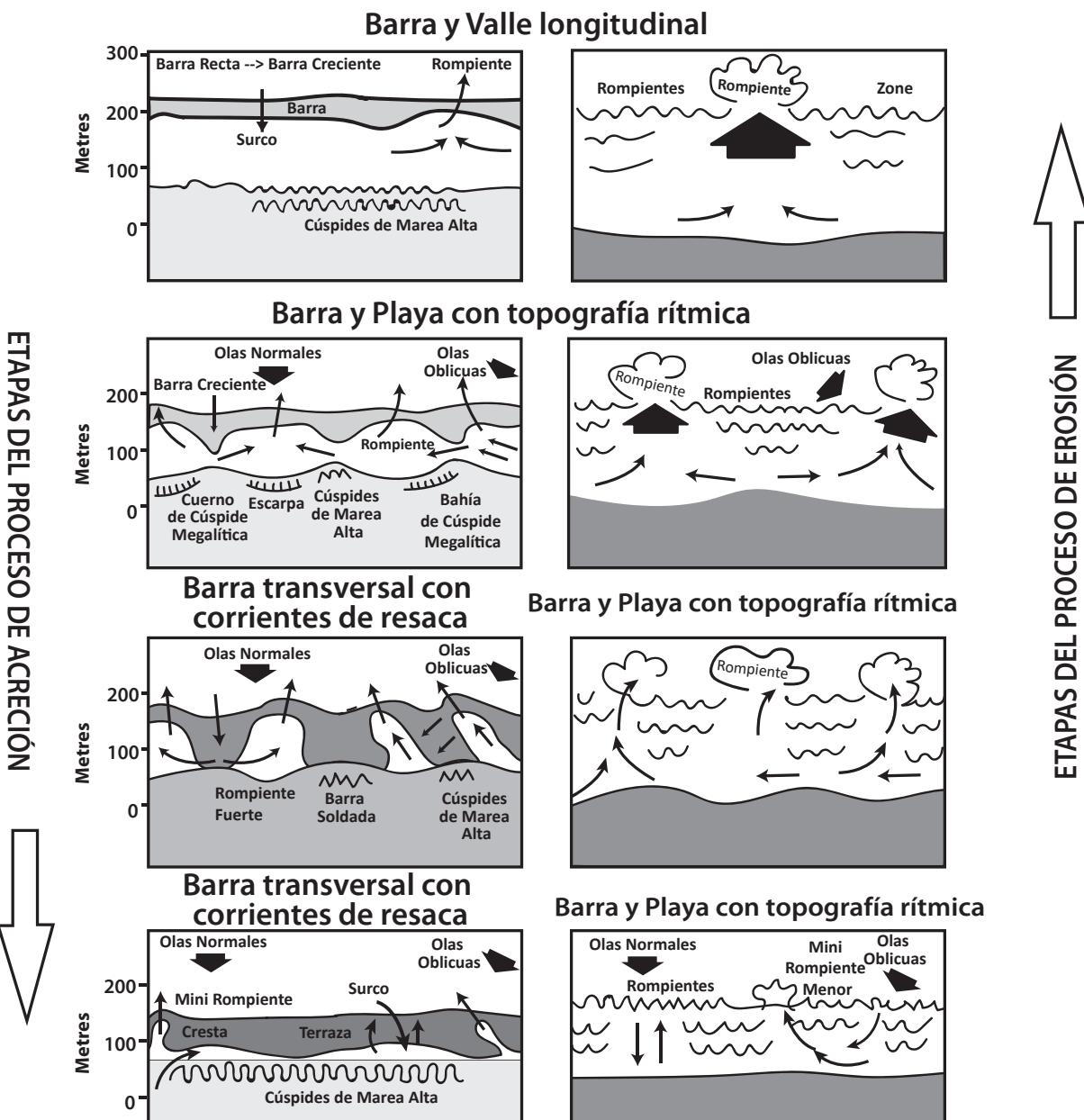
**Document 14** Vue en plan de la séquence des changements de la morphologie de la plage et de sa zone submergée dans un processus d'accréation (graphique de gauche) et dans un processus d'érosion (graphique de droite) (Short, (1999), basé sur Short, (1979); Wright et Short, (1984); Sunamura).
