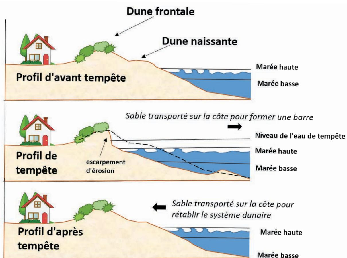
**Figura 21** Cycle typique d'érosion et d'accrétion des plages dans un cas sans perte permanente de sable. Adapté de l'État de Nouvelle-Galles du Sud et du Bureau de l'environnement et du patrimoine 2018.
