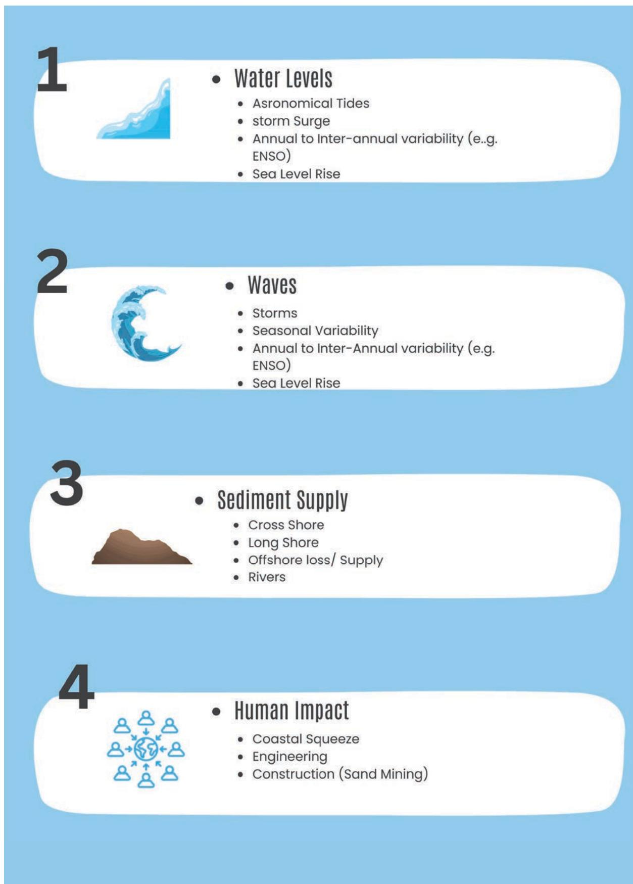
**Figura 18:** Factores que afectan la erosión costera y el transporte de sedimentos, de Splinter y Coco (2021).
