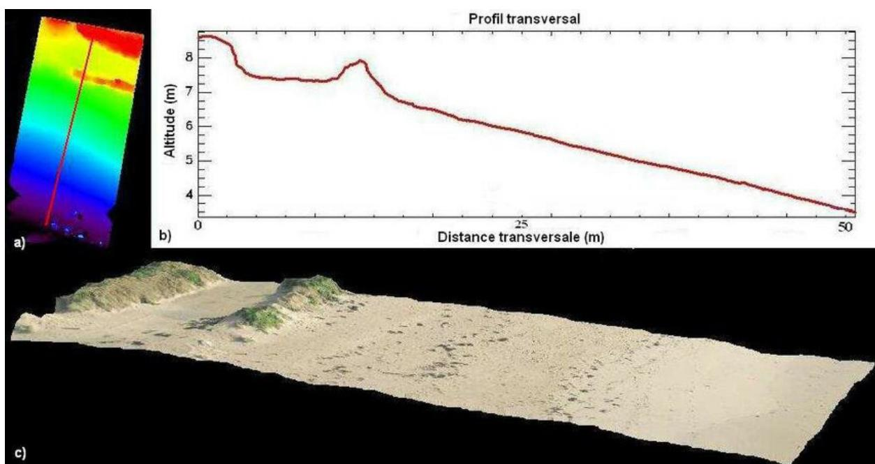
**Document 37** Traitement des données relatives aux profils de plage : à partir d'un relevé sur le terrain (à gauche) ou d'une extraction de MNE (à droite)
